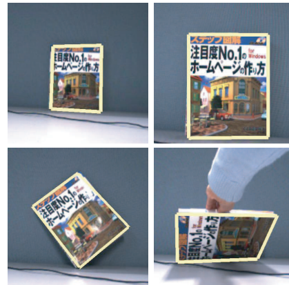
図 2: 位置合わせの様子 (対象と輪郭線が一致していれば位置合わせ成功である)
